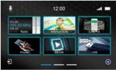
Um die Radiofunktion aufzurufen, drücken Sie im Hauptmenü auf Radio oder drücken Sie die Radio-Taste auf der Frontseite des Gerätes.
