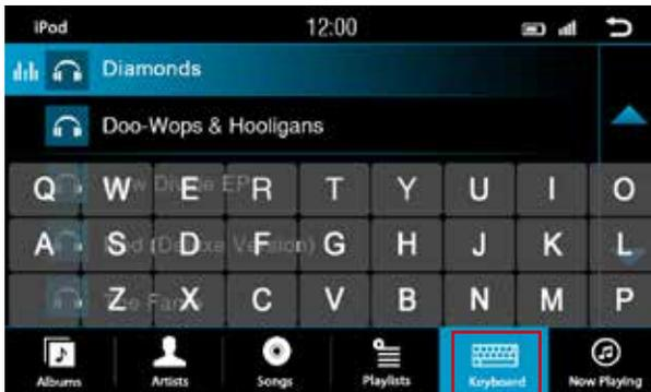
Wenn Sie den Inhalt des Ordners durchsuchen möchten, nutzen Sie die Suchfunktion im Menü. Durch einen Druck auf das Symbol der Tastatur öffnet sich die virtuelle Eingabemöglichkeit. Mit dem Anfangsbuchstaben können Sie den Inhalt durchsuchen. Verlassen Sie die Tastatur indem Sie auf eine leere schwarze Fläche drücken.
