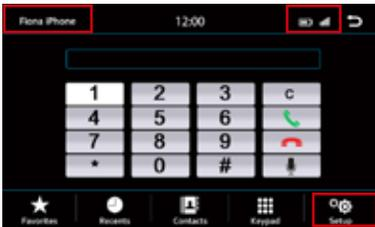
Wenn die **Verbindung hergestellt** wurde, wird Ihnen links oben der Name des Smartphones angegeben. Rechts oben werden der Ladezustand und die Feldstärke angezeigt, wenn das Smartphone die Informationen überträgt.
